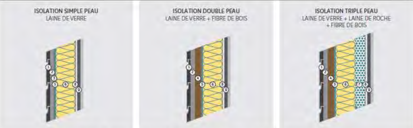
① Bardage bois 21 mm ② Tasseaux bois 25 mm ③ Pare-pluie ④ Fibre de bois pare-pluie 40 mm, R = 1.00m^2K/W ⑤ Contreventement ⑥ Laine de verre 120 mm, R = 3.75m^2K/W ⑦ Laine de roche 50 mm, R = 1.45m^2K/W ⑧ Frein-vapeur ⑨ Doublet plaque de plâtre sur rails métalliques
